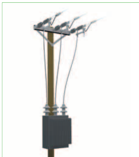
Připojení sloupové trafostanice
