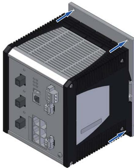
Abb. 2: RSR20/RSR30-Gerät auf Wandmontageplatte aufrasten, mit 4 Schrauben an der Wand festschrauben
