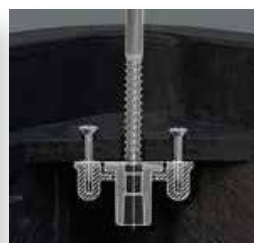
Systém skrutiek bez rozmerov Umožňuje výmenu v teréne
