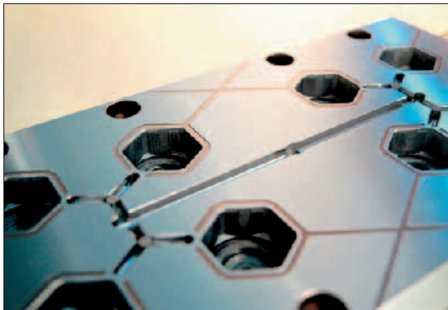
Precision tool for moulding cable glands Spritzgusswerkzeug für Kabelverschraubungen
