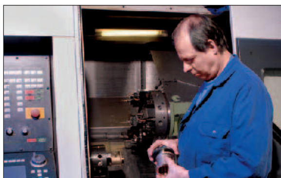
Accurate metal machining with CNC lathe Exakte Metallbearbeitung auf CNC-Drehautomat
